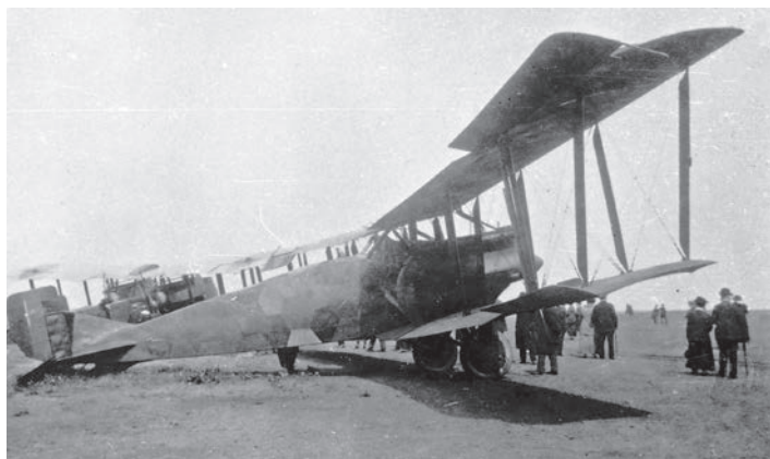
Na de Wapenstilstand, in 1919, stonden te Evere een aantal Gotha's als oorlogsbuit tentoongesteld. Deze tweemotorige Duitse bommenwerpers konden makkelijk een ton vervoeren. Enkele ervan werden getest, onder meer voor passagiersvervoer. Het Duitse Balkenkreuz op de staart was overschilderd met de Belgische driekleur.
