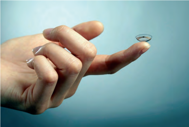
Afbeelding 1.5: Wearables zijn in opmars. Hier een contactlens die het glucosegehalte bij diabetes meet.
