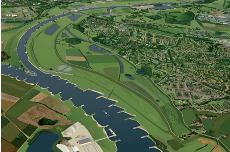
FIGUUR 1.3A + 1.3B Ruimte voor de rivier: De Hondsbroecksche Pleij bij Westervoort is een voormalige uiterwaard op de oever van de Neder-Rijn en de IJssel. De dijk wordt verlegd, waardoor het rivierwater (boven weergegeven bij normale waterstand) wijd uit kan stromen bij hoog water (onder).
